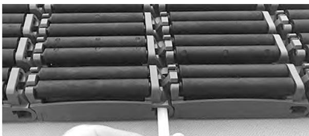
**Figura 240:** Inserire il perno nelle cerniere
