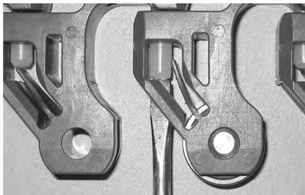
Figura 278: Spingere il perno oltre il dispositivo di ritenzione
