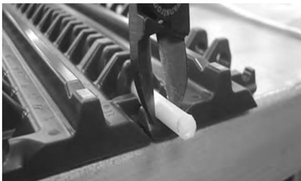
**Figura 72:** Estrazione del perno dal nastro
