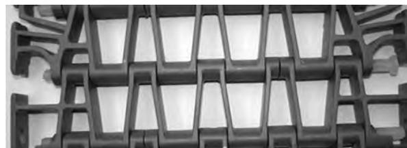
**Figura 255:** Assicurarsi che il perno sia inserito oltre il dispositivo di ritenzione
