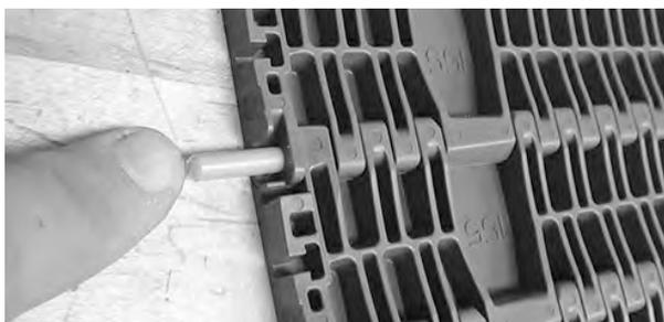
**Figura 266:** Inserimento del perno
