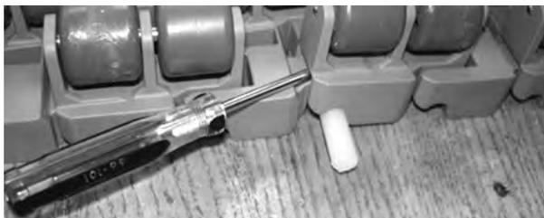
**Figura 195:** Estrazione del perno dal nastro
