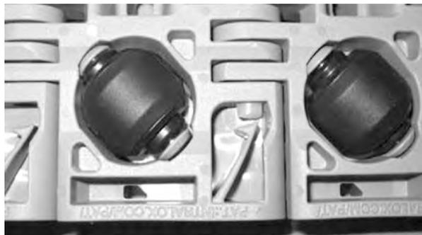
**Figura 226:** Assicurarsi che il perno sia inserito oltre il dispositivo di ritenzione
