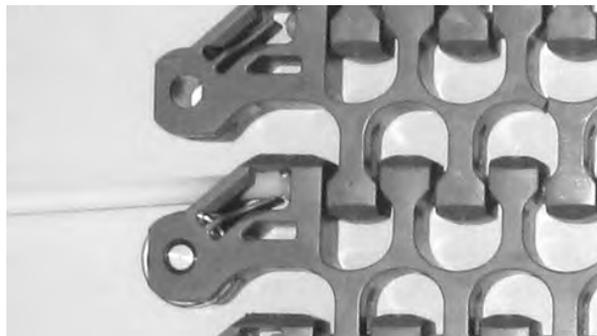
Figura 299: Estrazione del perno dal nastro
