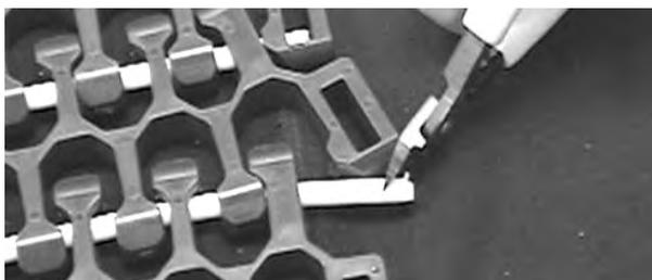
**Figura 312:** Estrazione del perno dal nastro
