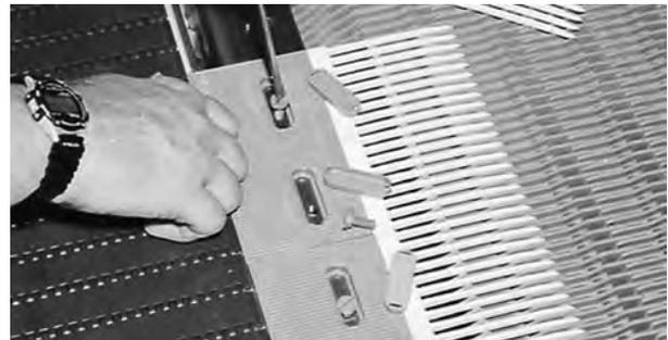
**Figura 18:** Installare i pettini di trasferimento utilizzando i bulloni in plastica Intralox
