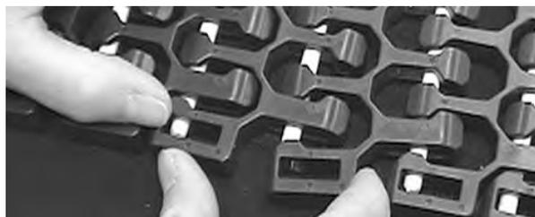
**Figura 307:** Spingere il perno oltre il bordo del nastro, far scattare il bordo a filo oltre il perno
