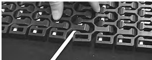
**Figura 304:** Inserire il perno nelle cerniere
