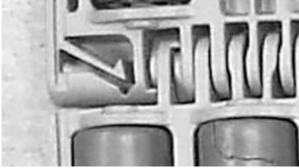
**Figura 223:** Assicurarsi che il perno sia inserito oltre il dispositivo di ritenzione
