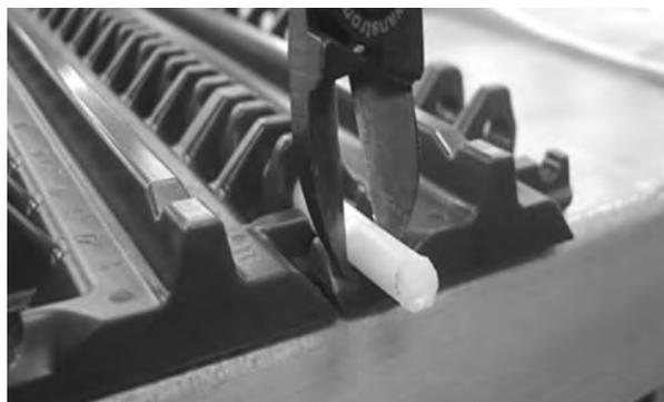
**Figura 101:** Estrazione del perno dal nastro
