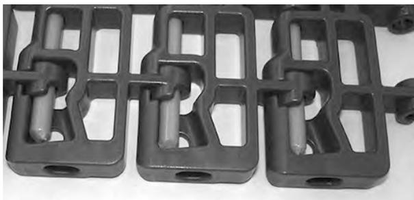
**Figura 117:** Il perno si espande nel bordo a filo
