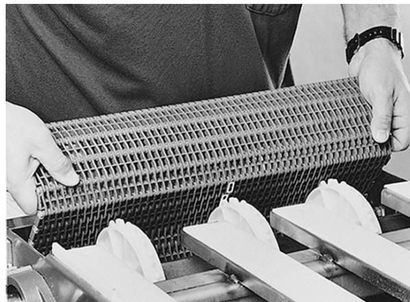
**Figura 12:** Avvolgere il nastro intorno ai pignoni di azionamento
