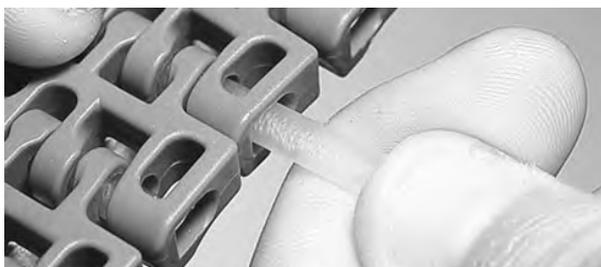
**Figura 135:** Inserire il perno nelle cerniere
