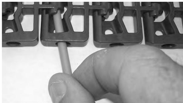
**Figura 122:** Inserire il perno nelle cerniere
