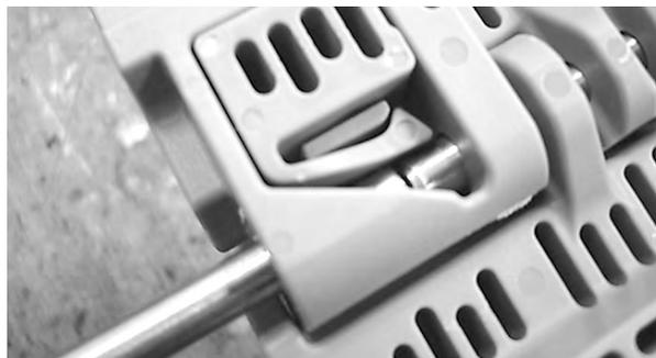
**Figura 104:** Spingere il perno oltre il dispositivo di ritenzione
