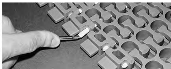
**Figura 271:** Assicurarsi che il perno sia inserito oltre il dispositivo di ritenzione
