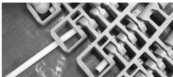
Figura 337: Inserire il perno nelle cerniere
