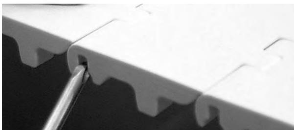
**Figura 204:** Spingere il perno oltre il dispositivo di ritenzione
