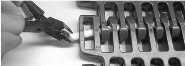
**Figura 334:** Estrazione del perno dal nastro
