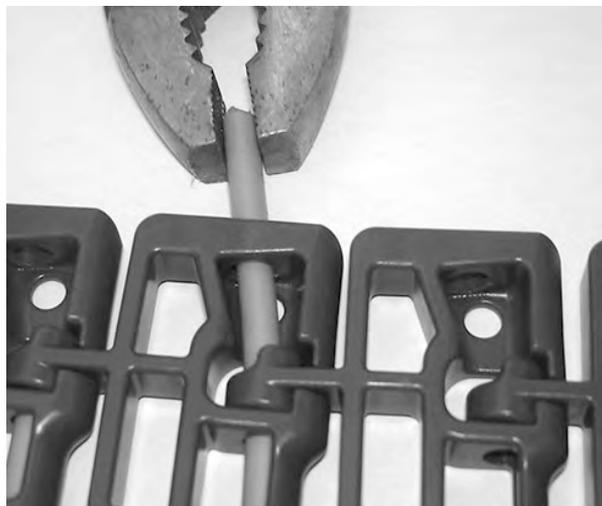
**Figura 126:** Estrazione del perno dal nastro
