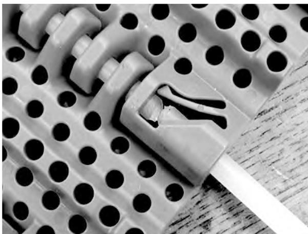
**Figura 85:** Spingere il perno oltre il dispositivo di ritenzione
