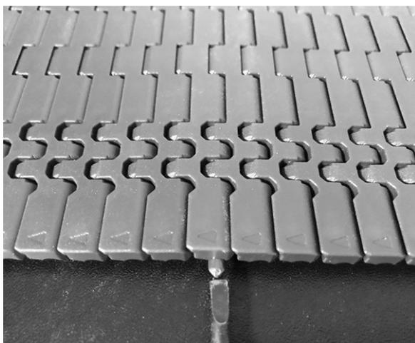
**Figura 59:** Spingere il perno oltre il dispositivo di ritenzione
