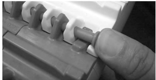
**Figura 77:** Spingere il perno oltre il dispositivo di ritenzione
