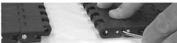
**Figura 160:** Utilizzare un cacciavite per chiudere lo Slidelox
