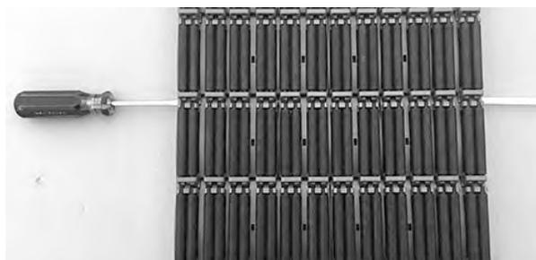
**Figura 243:** Allontanare il perno dal nastro
