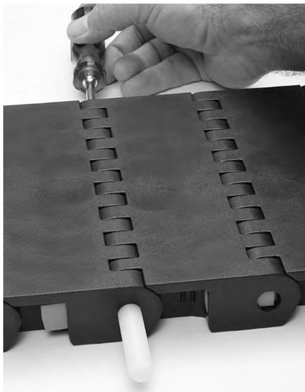
**Figura 263:** Allontanare il perno dal nastro
