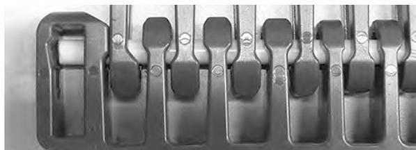
**Figura 332:** Assicurarsi che il perno sia inserito oltre il dispositivo di ritenzione
