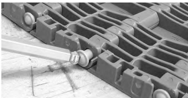
**Figura 267:** Spingere il pernetto oltre il dispositivo di ritenzione
