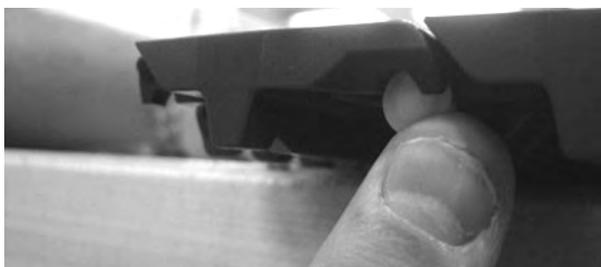
**Figura 98:** Spingere il perno oltre il dispositivo di ritenzione
