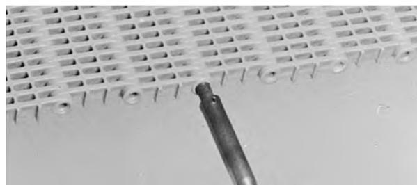
**Figura 30:** Chiudere il foro del perno
