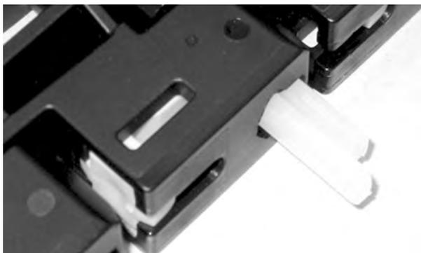
**Figura 185:** Inserire il perno nelle cerniere
