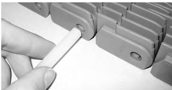
**Figura 215:** Inserire il perno nelle cerniere
