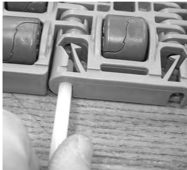
Figura 220: Aprire il dispositivo di ritenzione
