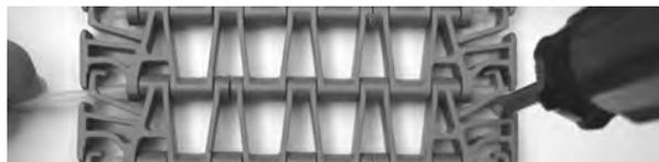
**Figura 250:** Allontanare il perno dal nastro
