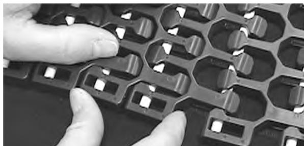
**Figura 308:** Assicurarsi che il perno sia inserito completamente
