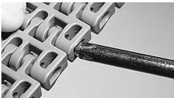
**Figura 145:** Spingere il perno oltre il dispositivo di ritenzione
