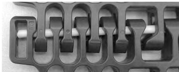
**Figura 315:** Assicurarsi che il perno sia inserito oltre il dispositivo di ritenzione
