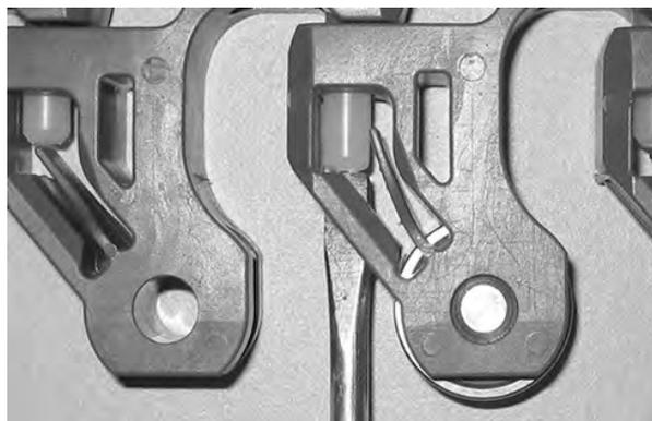
Figura 300: Spingere il perno oltre il dispositivo di ritenzione
