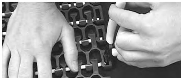
**Figura 309:** Spingere il perno nel nastro
