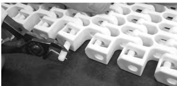
**Figura 291:** Estrazione del perno dal nastro
