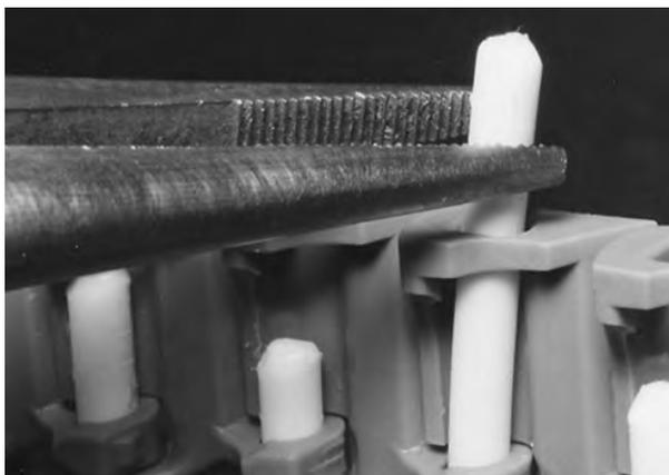
**Figura 149:** Estrazione del perno dal nastro
