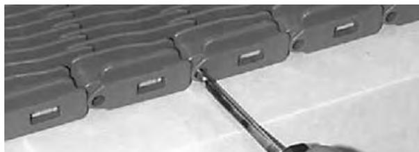
**Figura 44:** Allontanare il perno dal nastro
