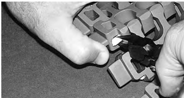
**Figura 273:** Liberare il perno dal dispositivo di ritenzione
