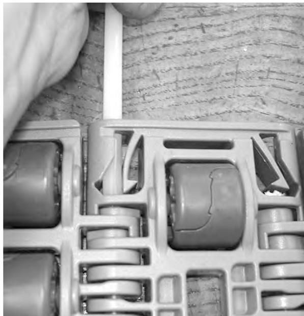
Figura 221: Allontanare il perno dal nastro
