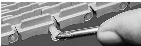
**Figura 22:** Spingere il perno nel nastro
