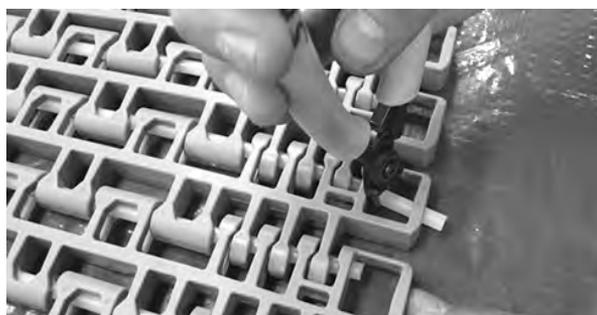
Figura 340: Estrazione del perno dal nastro
