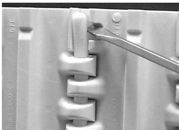
**Figura 206:** Sollevare il perno sopra il dispositivo di ritenzione
