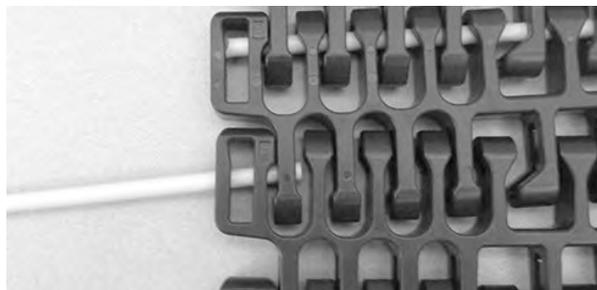
**Figura 313:** Inserimento del perno
