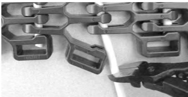
**Figura 329:** Estrazione del perno dal nastro
