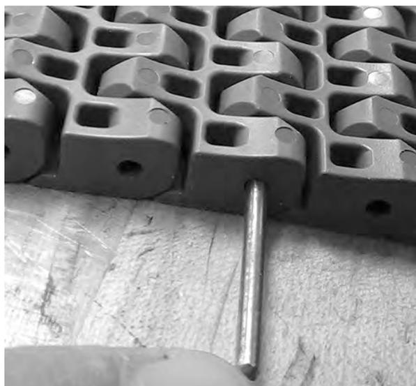
**Figura 269:** Allontanare il perno e il pernetto dal nastro
