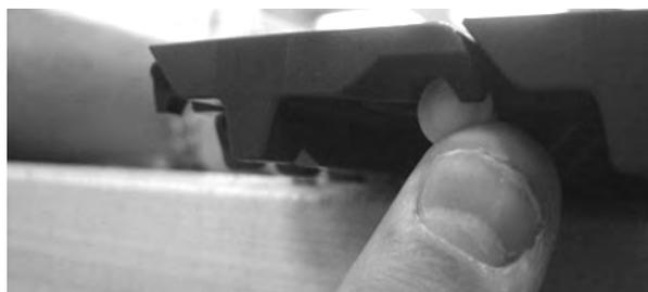
**Figura 69:** Spingere il perno oltre il dispositivo di ritenzione
