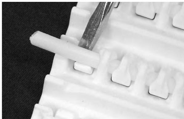
**Figura 176:** Sollevare il perno sopra il dispositivo di ritenzione
