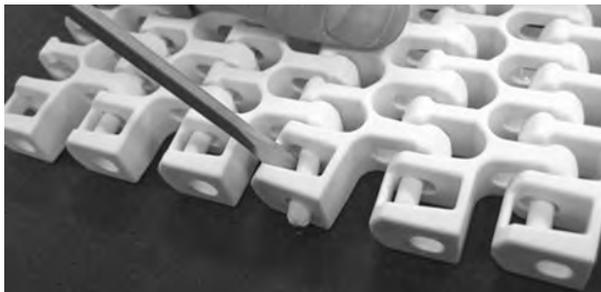
**Figura 290:** Spingere il perno attraverso il dispositivo di ritenzione
