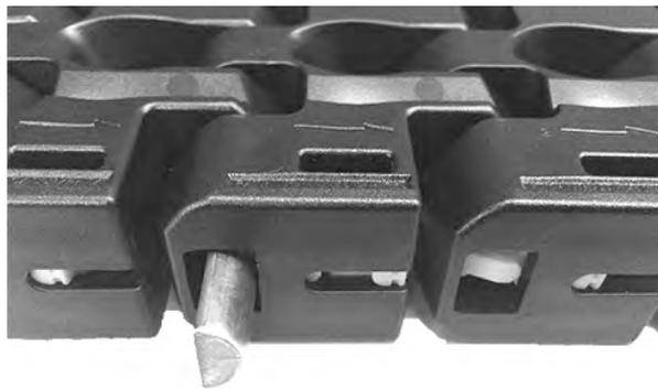
**Figura 199:** Inserimento del perno
