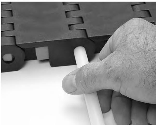
**Figura 261:** Inserimento del perno
