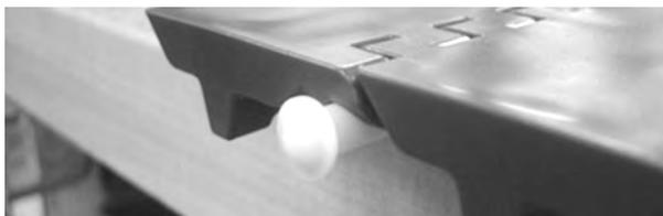
**Figura 67:** Inserire il perno nelle cerniere
