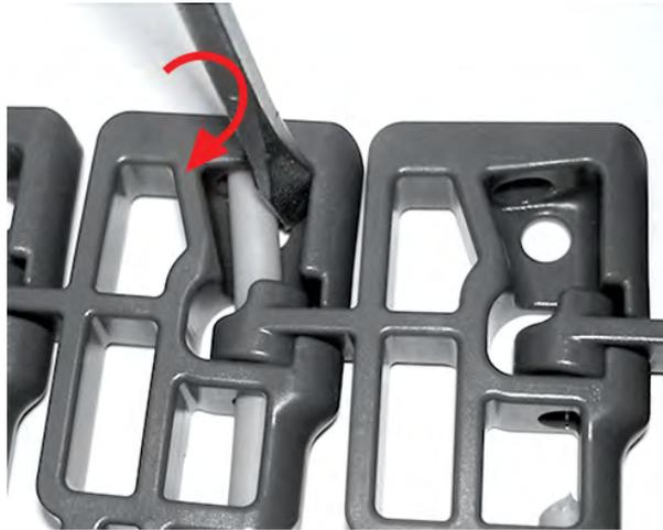
**A** Dispositivo di bloccaggio
