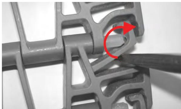
**Figura 249:** Ruotare il cacciavite per tenere aperto il dispositivo di ritenzione
