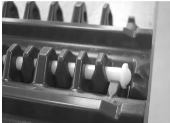
**Figura 70:** Assicurarsi che il perno sia inserito oltre il dispositivo di ritenzione
