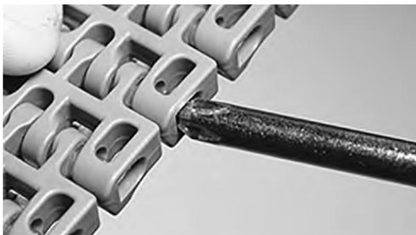
**Figura 136:** Spingere il perno oltre il dispositivo di ritenzione
