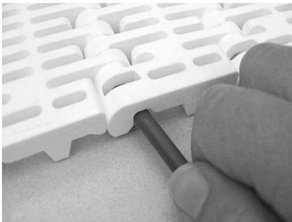
**Figura 79:** Spingere il perno nel nastro
