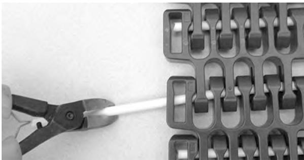
**Figura 317:** Estrazione del perno dal nastro
