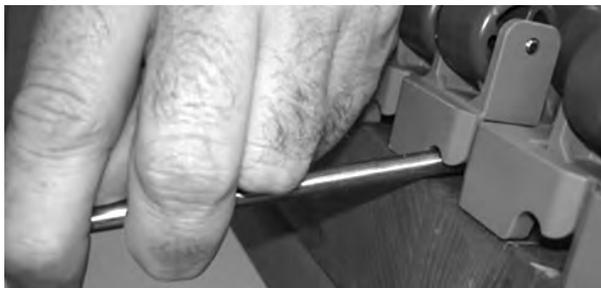
**Figura 193:** Inserire il perno in acciaio nella cerniera
