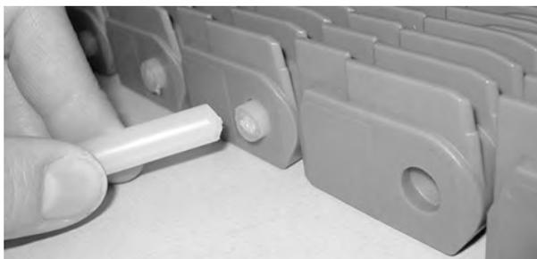
**Figura 216:** Spingere il perno oltre lo Shuttleplug
