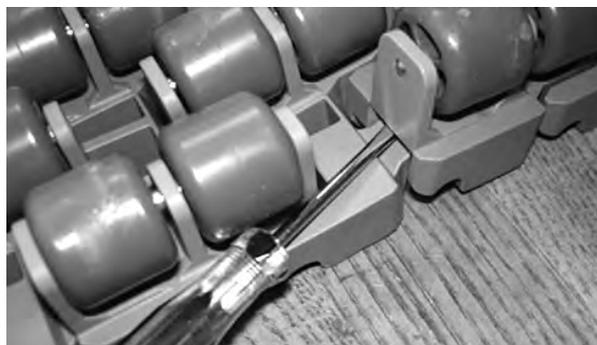
Figura 192: Inserire il cacciavite sotto il rullo
