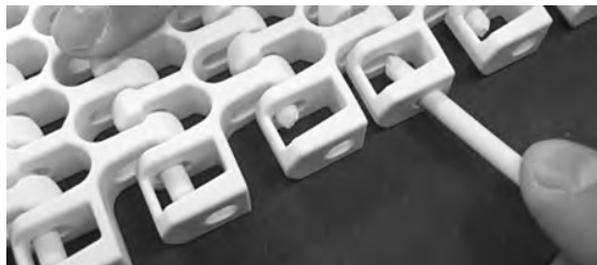
**Figura 287:** Inserire il perno nelle cerniere
