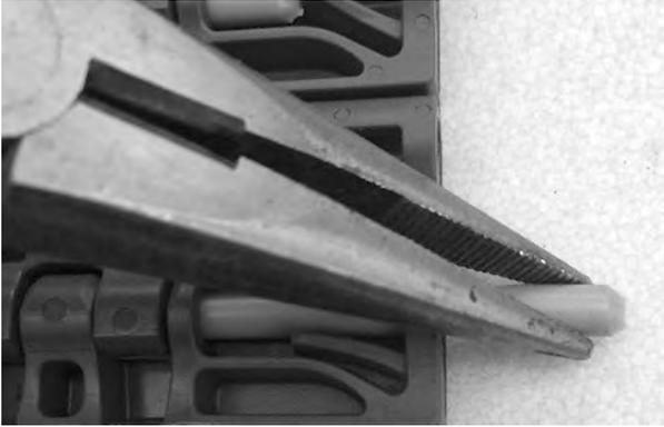
**Figura 131:** Estrazione del perno dal nastro
