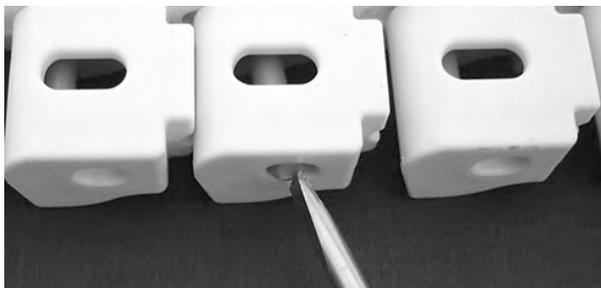
**Figura 283:** Spingere il perno oltre il dispositivo di ritenzione
