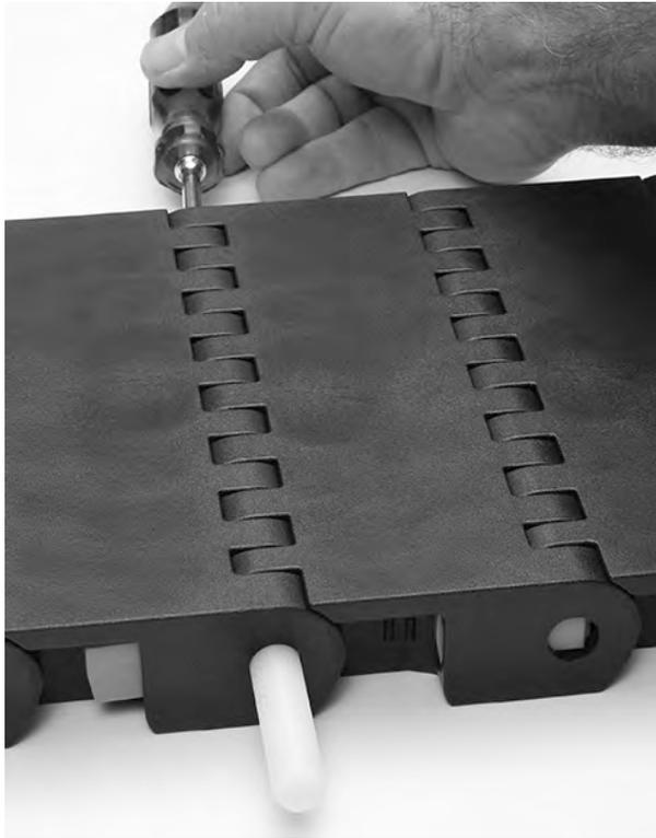
**Figura 259:** Allontanare il perno dal nastro
