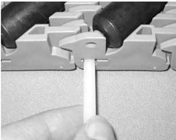
**Figura 224:** Inserire il perno nelle cerniere
