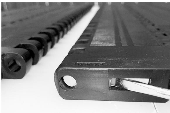
**Figura 209:** Utilizzare un cacciavite per chiudere lo Slidelox
