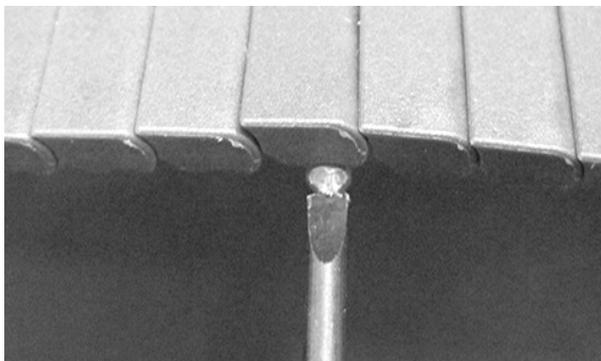
**Figura 54:** Spingere la testa del perno oltre il dispositivo di ritenzione
