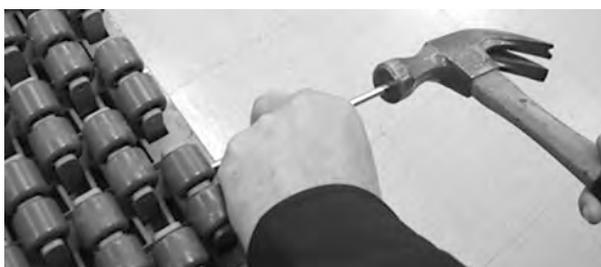
**Figura 194:** Allontanare il perno dal nastro
