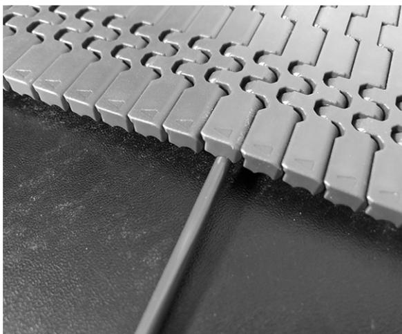
**Figura 58:** Inserimento del perno
