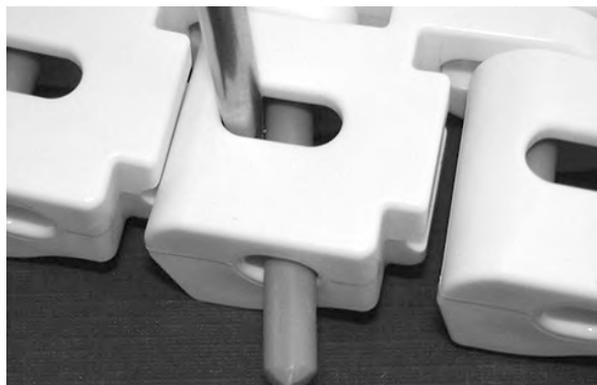
**Figura 285:** Spingere il perno attraverso il dispositivo di ritenzione
