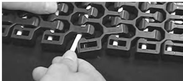
**Figura 306:** Inserire il perno nelle cerniere
