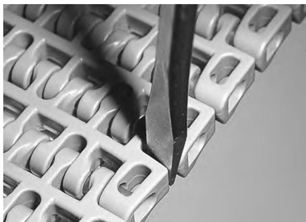
**Figura 138:** Spingere il perno oltre il dispositivo di ritenzione
