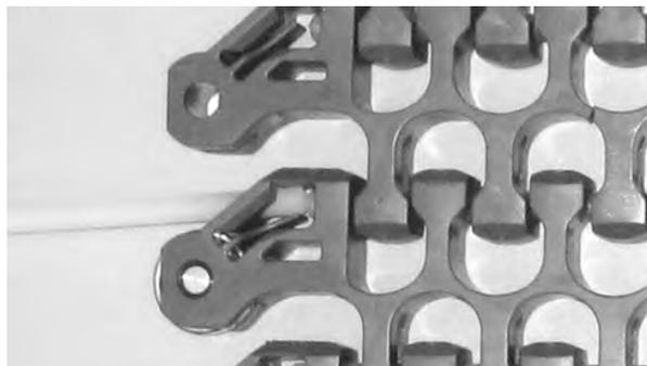
Figura 281: Allontanare il perno dal nastro
