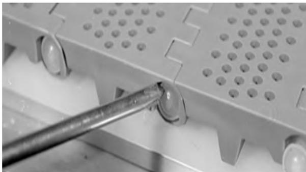
**Figura 64:** Assicurarsi che la testa del perno superi il dispositivo di ritenzione a scatto
