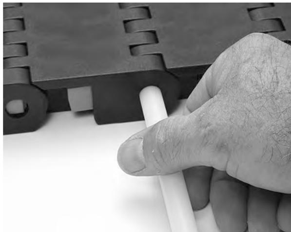
**Figura 258:** Inserimento del perno
