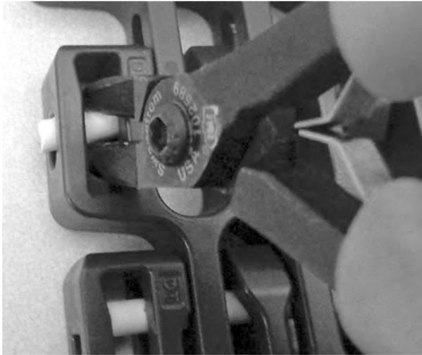
**Figura 316:** Spingere il perno lateralmente e oltre il foro
