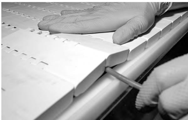
**Figura 88:** Piegarlo leggermente il perno e inserirlo attraverso le cerniere
