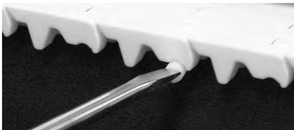
**Figura 174:** Spingere il perno oltre il dispositivo di ritenzione
