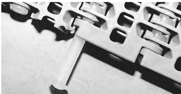
**Figura 28:** Inserimento del perno
