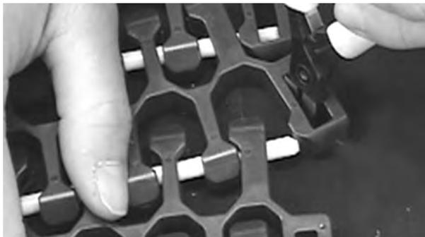
**Figura 310:** Flettere il bordo a filo del modulo sul perno libero
