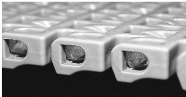
**Figura 146:** Assicurarsi che il perno sia inserito oltre il dispositivo di ritenzione
