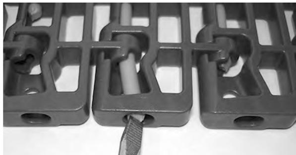
**Figura 123:** Spingere il perno oltre il dispositivo di ritenzione
