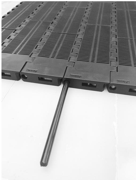
**Figura 210:** Inserimento del perno
