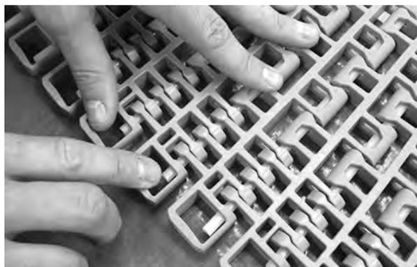
Figura 339: Assicurarsi che il perno sia inserito oltre il dispositivo di ritenzione
