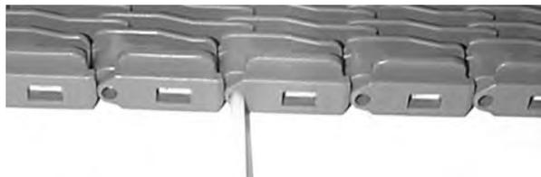
**Figura 41:** Inserimento del perno
