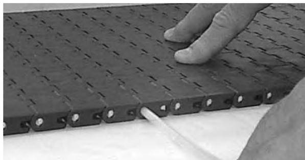
**Figura 161:** Inserimento del perno
