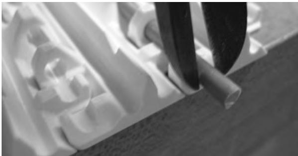
**Figura 183:** Estrazione del perno dal nastro
