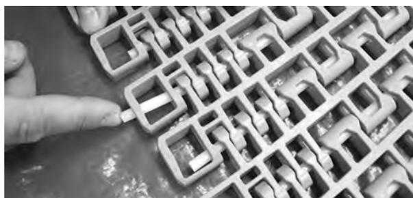
Figura 338: Spingere il perno oltre il dispositivo di ritenzione
