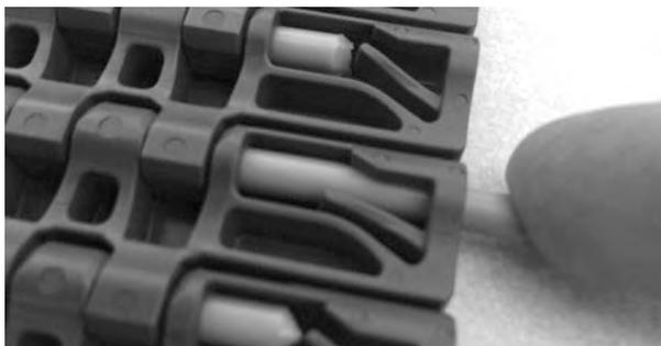
**Figura 127:** Inserire il perno nella cerniera
