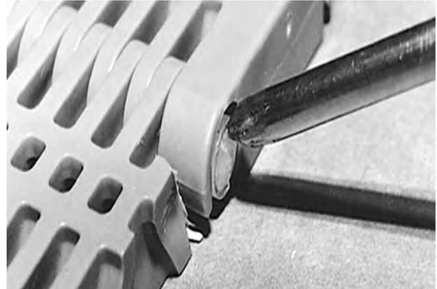
**Figura 48:** Spingere la testa del perno oltre il dispositivo di ritenzione
