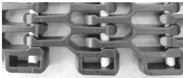
**Figura 326:** Assicurarsi che il perno sia inserito completamente
