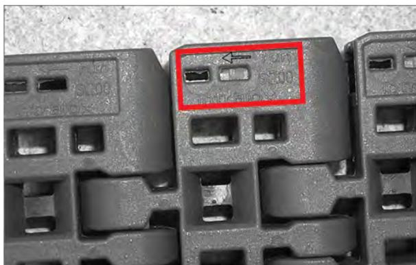
Figura 154: Direzione di scorrimento del nastro
