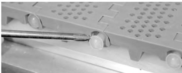
**Figura 63:** Spingere il perno nel nastro
