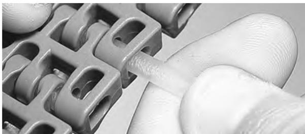
**Figura 144:** Inserire il perno nelle cerniere
