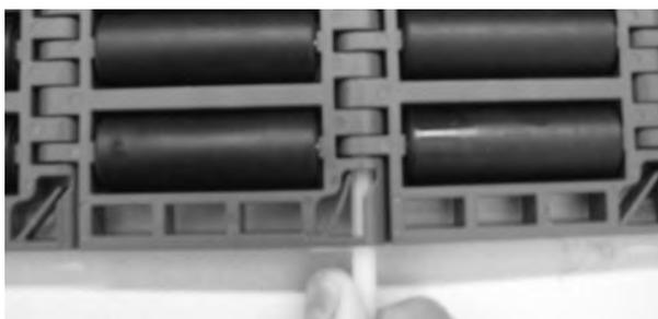
**Figura 236:** Inserire il perno nelle cerniere
