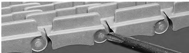
**Figura 23:** Assicurarsi che la testa del perno superi il dispositivo di ritenzione a scatto
