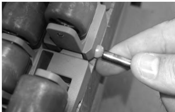
Figura 190: Spingere il perno oltre il dispositivo di ritenzione
