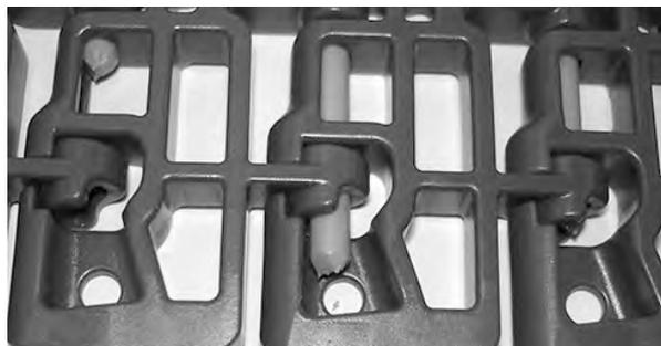
**Figura 124:** Assicurarsi che il perno sia inserito completamente
