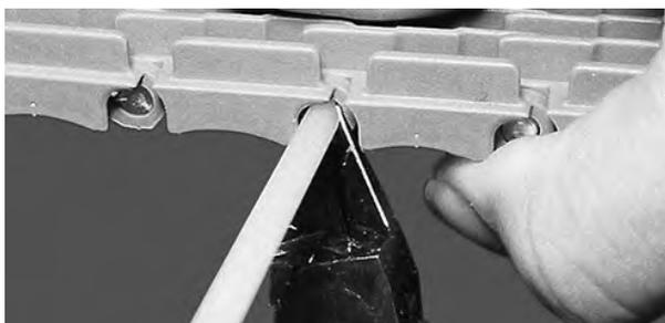
**Figura 24:** Tagliare il perno a filo con il bordo del nastro
