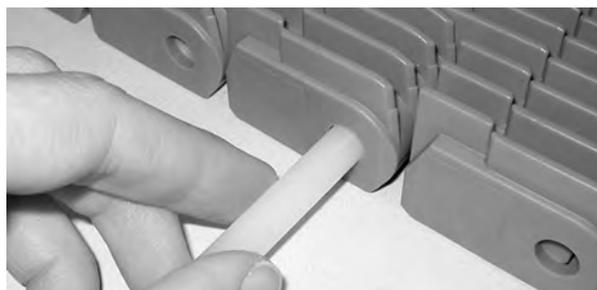
**Figura 218:** Estrazione del perno dal nastro
