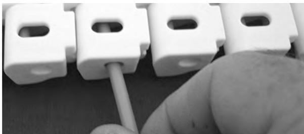
**Figura 282:** Inserire il perno nelle cerniere
